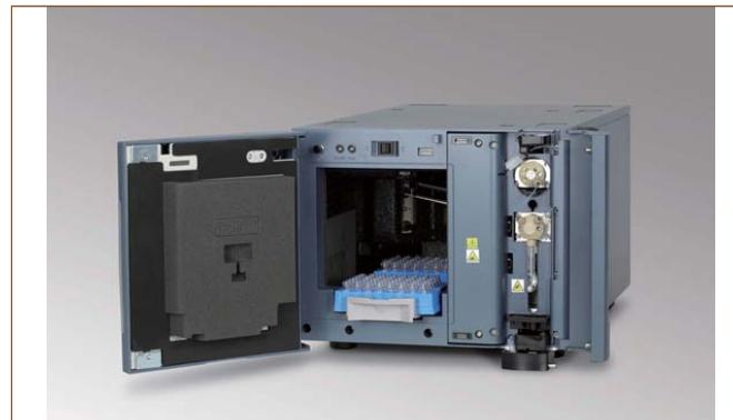
図 3. WFM-A のサンプルコンパートメント、洗浄シリンジ、流路切替バルブ
